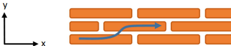
Draufsicht auf eine Polymer-Schicht im Halbleiter
